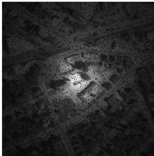
Figura 9: Imagen afectada con el modelo de degradación multiplicativa con ruido aditivo e impulsivo
