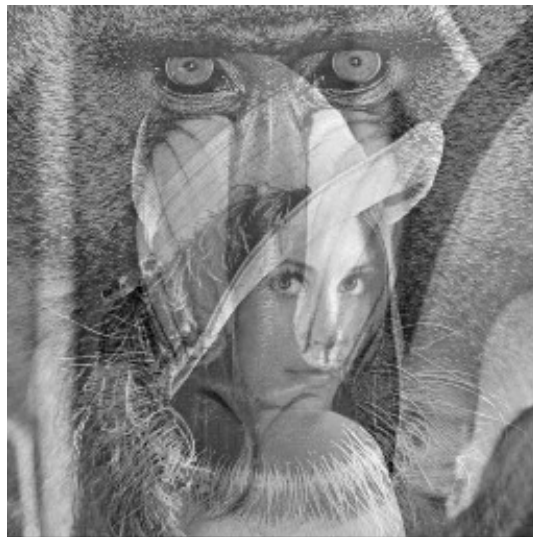
(c) Imagen degradada observada con interferencia aditiva y ruido blanco con \sigma = 2
