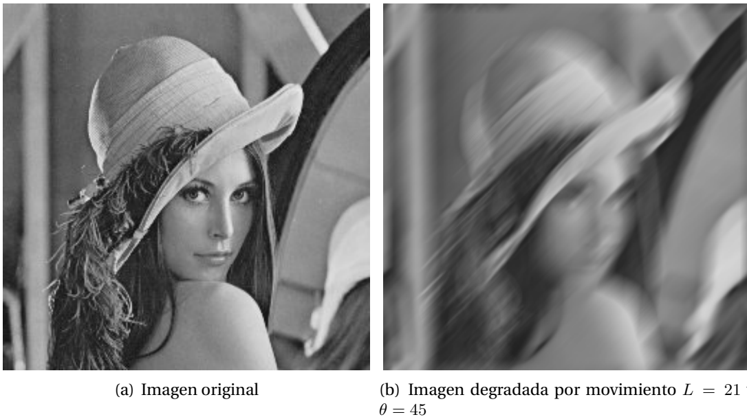
Figura 3: Modelo de degradación lineal con un emborronamiento por movimiento
