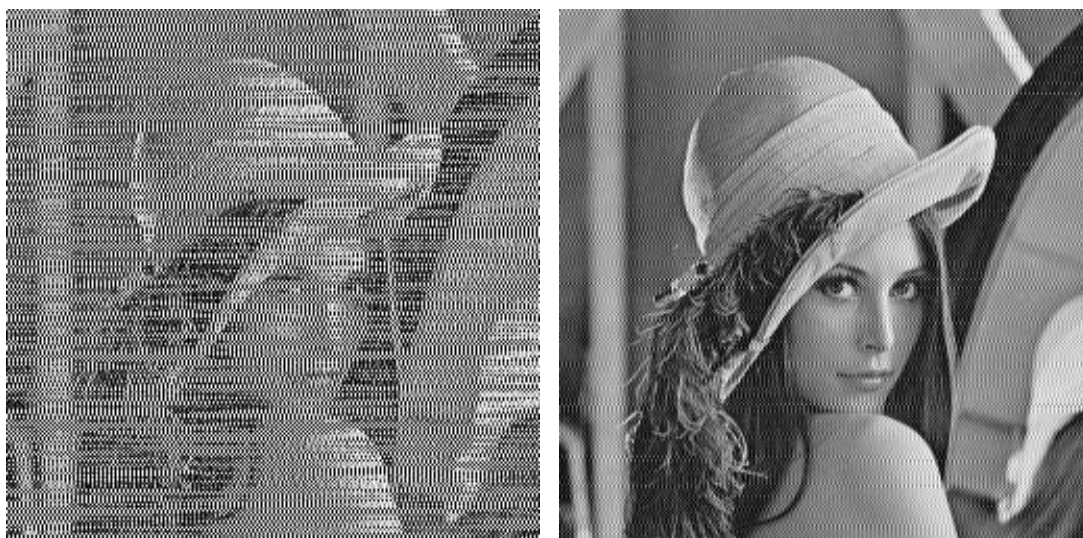
(c) Imagen (a) mas ruido aditivo ( SNR = 40 ) restaurada utilizando el filtro pseudoinverso (d) Imagen (a) mas ruido aditivo ( SNR = 60 ) restaurada utilizando el filtro pseudoinverso
