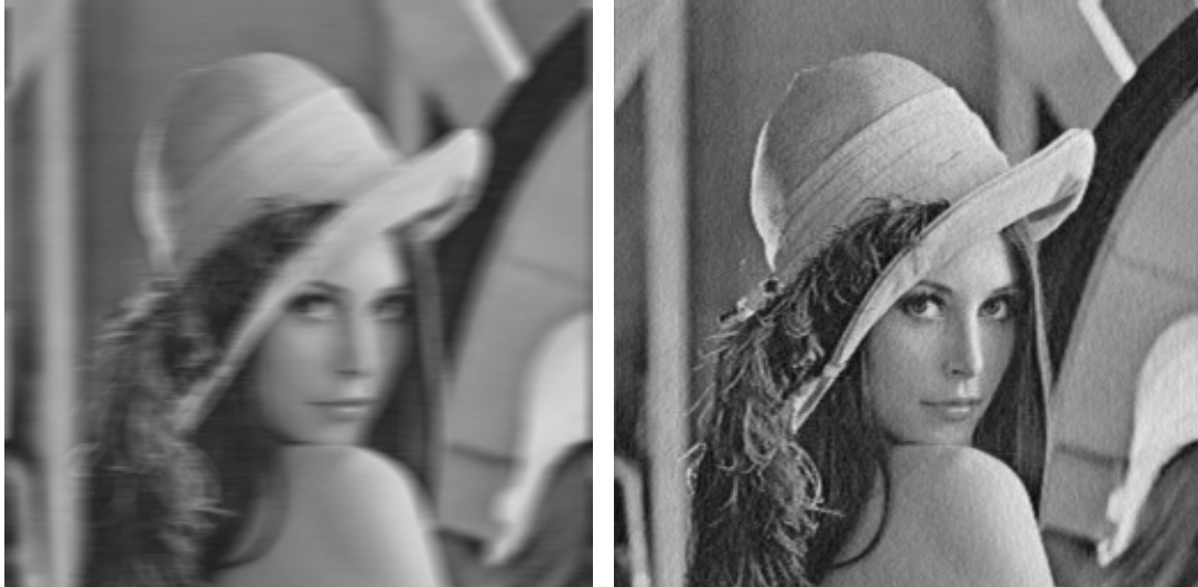
(a) Imagen degradada por movimiento ( L = 10 ) y ruido aditivo SNR = 40 y (b) Imagen (a) restaurada utilizando el filtro Wiener
