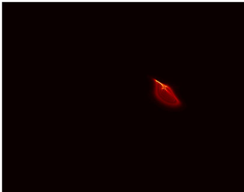
**Figura 64.** Imagen en el plano final de la propagación en el modelo de Kasprzak con la combinación de las aberraciones tip, astigmatismo y coma.
