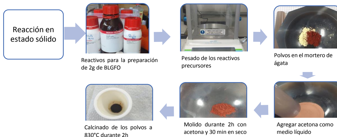
Figura 16. Esquema de la ruta para la preparación de las cerámicas Bi_{1-x}La_{0.10}FeO_3 (BLFO) y Bi_{1-x}La_{0.10}Gd_xFeO_3 (BLGFO) por reacción en estado sólido.
