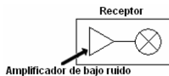
Figura 14. Esquema simplificado del receptor con el amplificador de bajo ruido.
