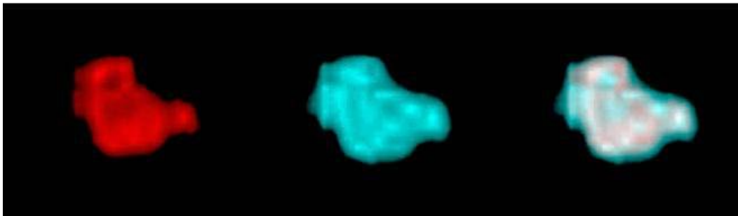
Figura 11. Comparación de distribución espacial de intensidad a la salida del AOS entre haz de entrada con potencia fuerte (2.51 mW, izquierda, rojo), contra un haz con potencia débil (0.2 mW, centro, cían), el resultado de la suma de ambos se encuentra a la derecha.
