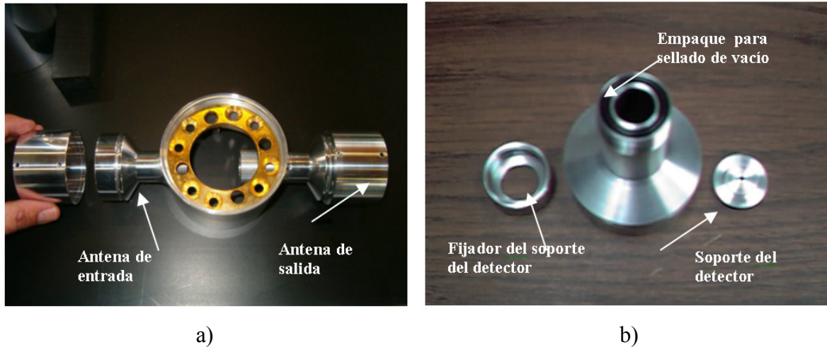
Figura 46. a) Antenas de corneta, b) alimentador y soporte para el detector.
