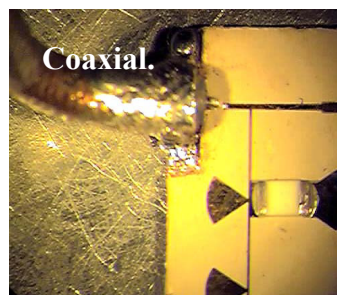
Figura 60. Conexión del amplificador con las guías de onda.
