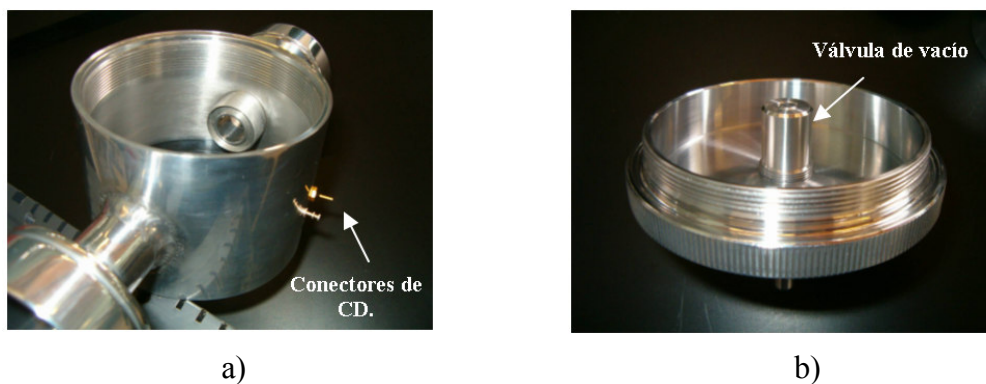
Figura 57. a) Cámara superior, b) tapa de la cámara.
