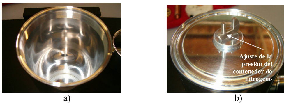
Figura 56. a) Vista superior de la cámara inferior, b) vista inferior.
