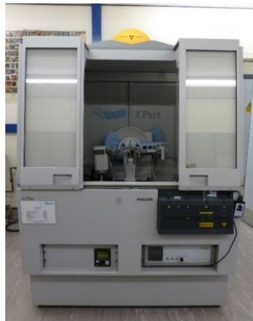
**Figura 20.** Equipo de difracción de rayos-X, Panalytical X'pert Pro MRD (XRD).
