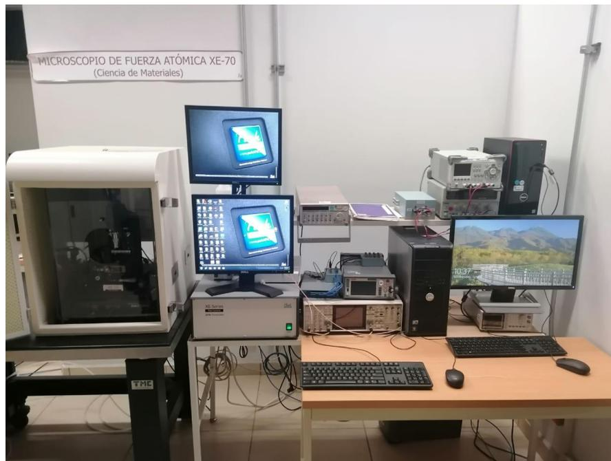
**Figura 22.** Microscopio de fuerza atómica Park system, modelo XE-70.
