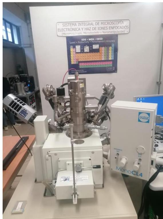
**Figura 21.** Microscopio electrónico de barrido.
