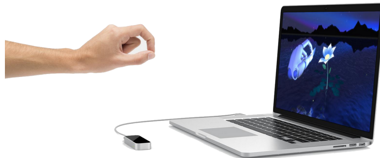
Figura 3: Ejemplo del reconocimiento del gesto usando Leap Motion, mostrando una aplicación donde los gestos son representados en 3D. Leap Motion es el dispositivo que se encuentra conectado a la laptop. Imagen recuperada de 13 .
