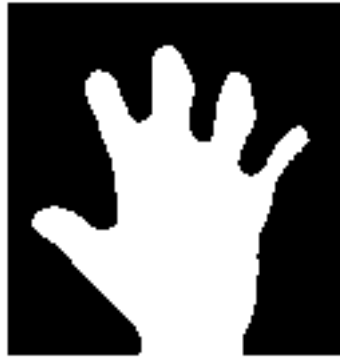
Figura 32: Binarización de ROI y aplicación de las operaciones morfológicas de la mano localizada en la Figura anterior.
