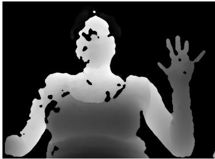
Figura 28: Imagen capturada por el Kinect, a la cual se le aplicó un filtro de mediana.
