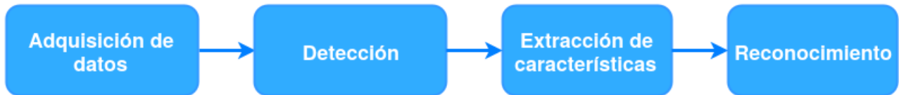
Figura 5: El diagrama ejemplifica el procedimiento del reconocimiento de gestos.
