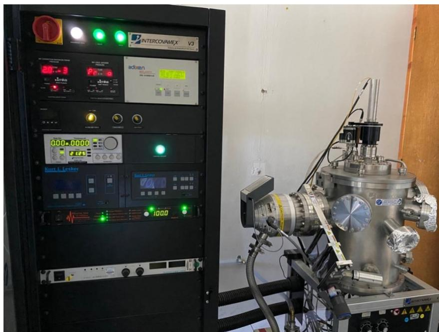
**Figura 21.** Equipo de Erosión Iónica INTERCOVAMEX.
