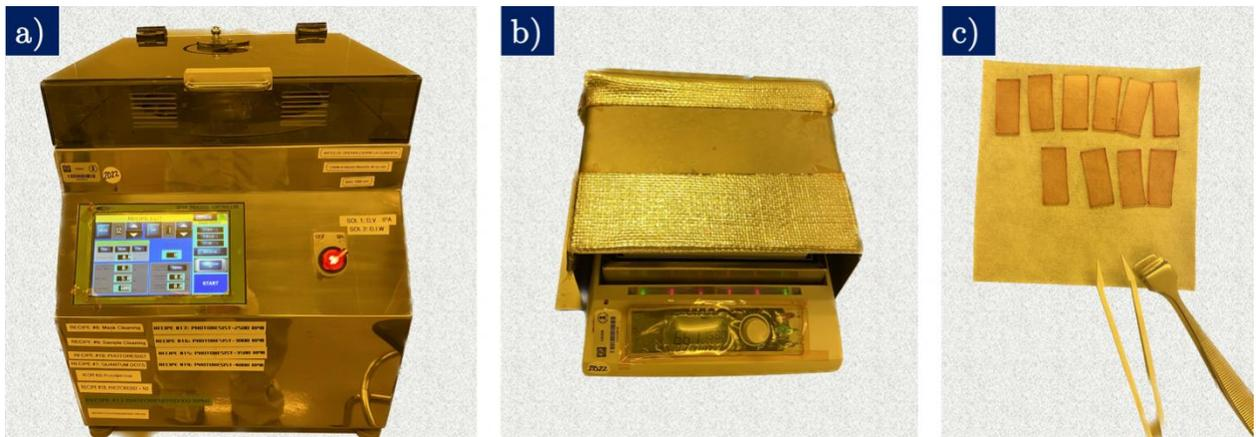
**Figura 28.** Depósito de la fotoresina: **a)** equipo MIDAS SPIN-3000TD para la técnica de depósito por centrifugado, **b)** plancha térmica Hot Plate AS ONE Corporation y **c)** sustratos con fotoresina después del proceso de secado.
