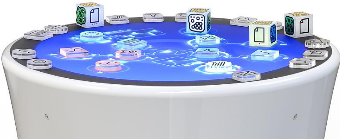
Figura 6. Mesa interactiva Reactable, sobre ella se encuentran los llamados “pucks” o discos.
