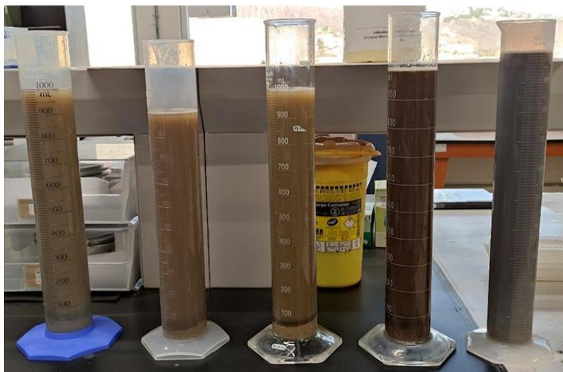
**Figura 11.** Probetas colocadas para las pruebas de Bouyoucos.
