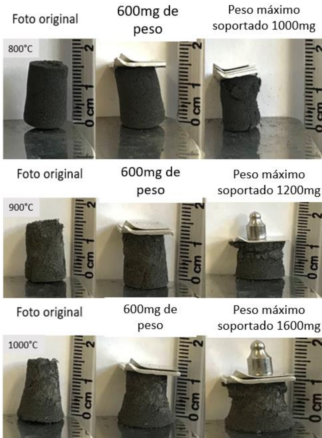
Figura 20. Deformación de los aerogeles en estado de compresión, al ser expuestos a un peso (presión) conocida; cada uno de los aerogeles tratados térmicamente a distintas temperaturas fueron capaces de soportar diferentes pesos. Puede observarse la mayor flexibilidad a medida que la temperatura del tratamiento térmico fue mayor, como se muestra ante un peso constante (600mg) y el grado de compresión adquirido. El aerogel de mayor rigidez (800 C) terminó siendo el que soportó un menor peso, con un peso máximo soportado de 1000 mg.
