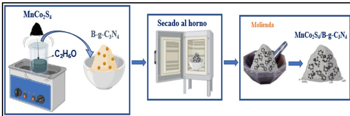
**Figura 9.** Síntesis de xMnCo<sub>2</sub>S<sub>4</sub>/B-g-C<sub>3</sub>N<sub>4</sub> por impregnación incipiente.
