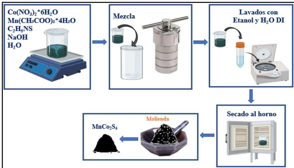
**Figura 8.** Síntesis hidrotermal de MnCo<sub>2</sub>S<sub>4</sub>.
