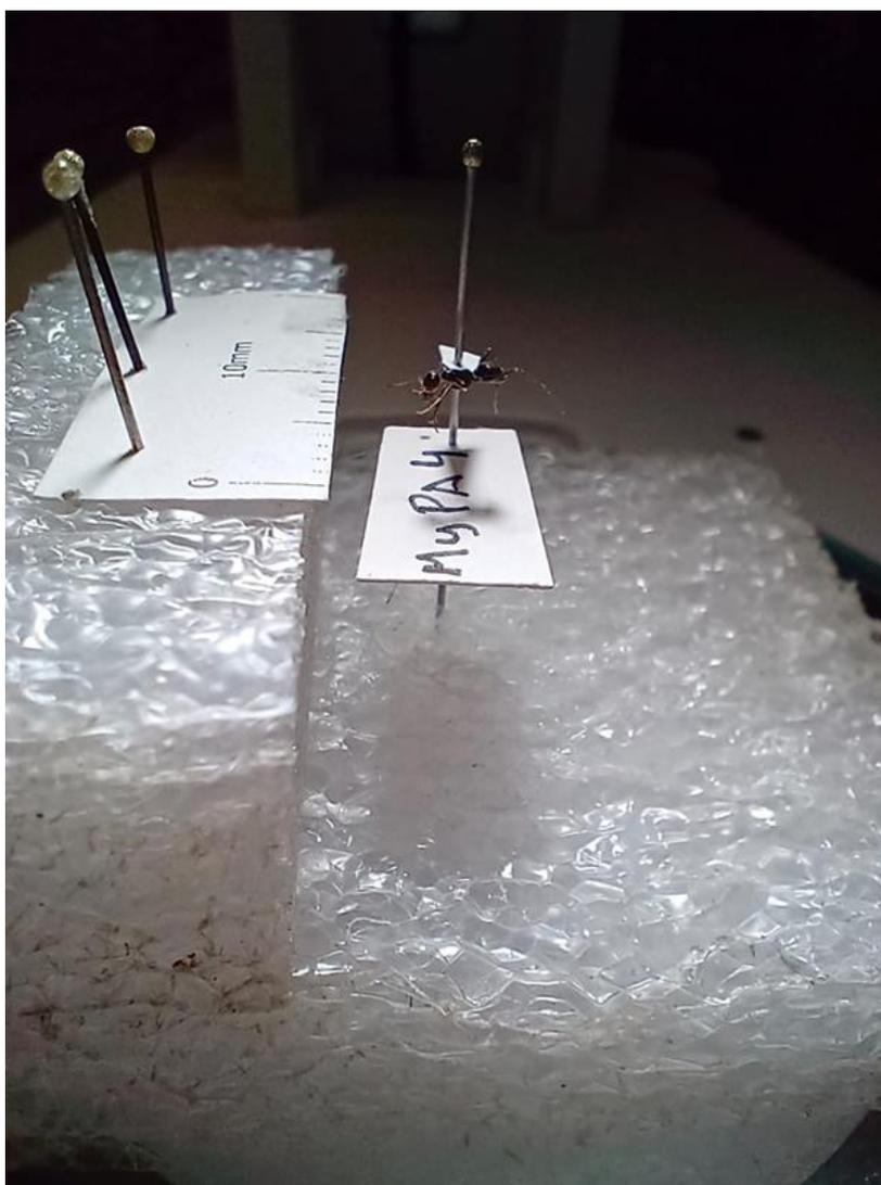
**Figura 8.** Fotografía de la plataforma de unicel de 2 cm de alto, para la estandarización con respecto a la distancia focal del microscopio.
