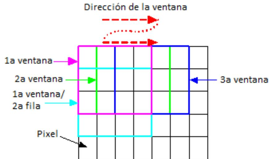
**Figura 12: Ventana deslizante.** La ventana avanza un número determinado de píxeles por iteración (en el ejemplo 1 píxel) hasta que termina la fila, luego baja un píxel y repite el proceso. Imagen recuperada de <http://www.ece.neu.edu/groups/rcl/projects/SWO/index.htm>.
