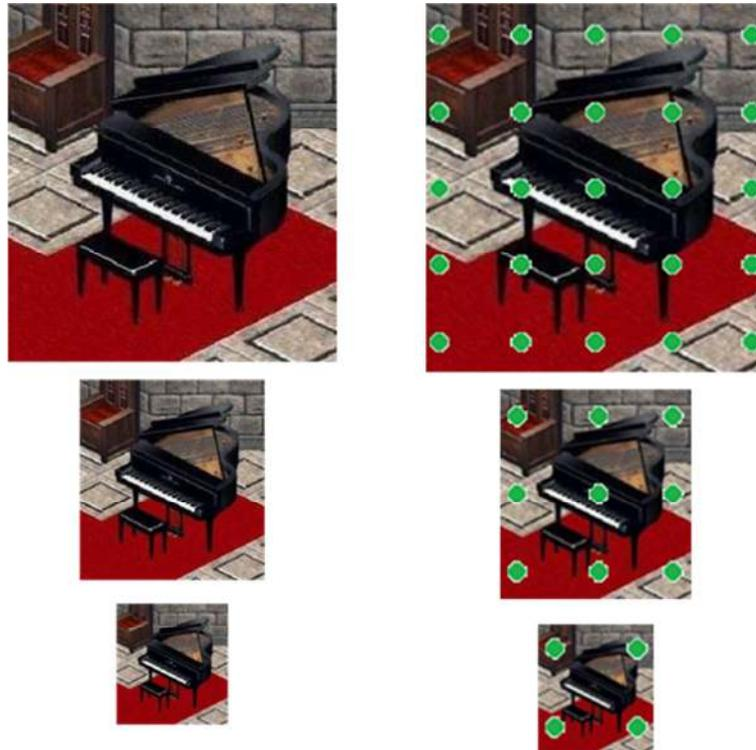
**Figura 13: Espacio de escala SIFT. Se selecciona un conjunto de puntos equidistantes en las imágenes del espacio de escala sin importar su factor de escala.**
