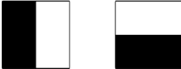
**Figura 9: Filtros Haar. Izquierda, gradiente en x, derecha gradiente en y. La zona negra = 1, zona blanca = -1. Los filtros Haar en imágenes integrales requieren solo 6 operaciones. Imagen recuperada de Bay et al., 2008. 351 p.**
