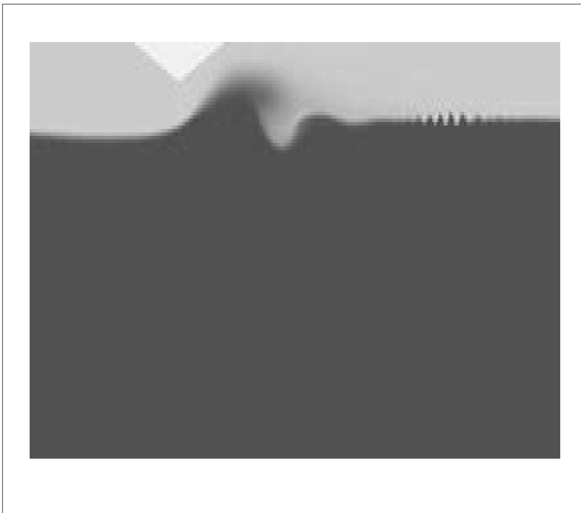
Figura 51: Distribución de la densidad en todo el dominio después de 3000 iteraciones en el tiempo con \Delta t = .01 .
