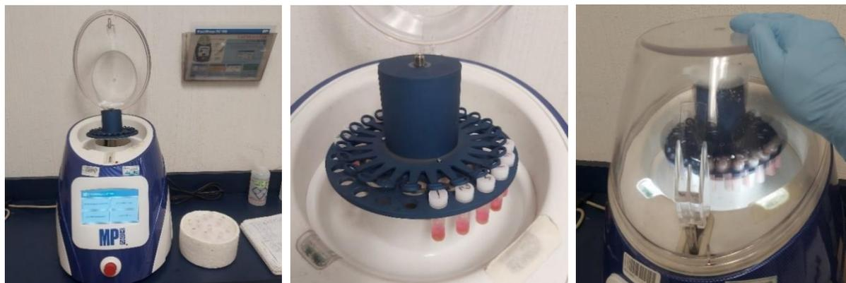
Figura 17. Homogeneización del tejido para la extracción de RNA.
