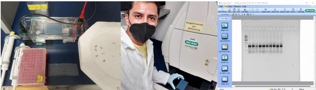
**Figura 25.** Electroforesis en cámara Biorad con TAE 1x (izquierda), posicionamiento del gel en el fotodocumentador (centro) y visualización de las bandas de ácidos nucleicos con software Image Lab.
