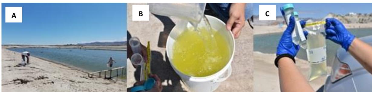
**Figura 10.** Muestreo de agua. A. Colecta de agua en un punto del estanque de cultivo, B. Mezcla del agua de al menos dos puntos de muestreo y C. Muestra final de 500 mL.
