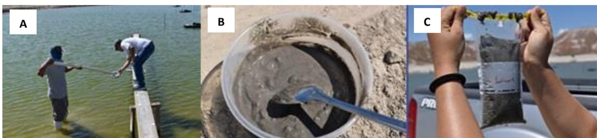
**Figura 11.** Muestreo de sedimento de un estanque de cultivo. A. Colecta de sedimento con un tubo PVC de 1 in de grosor, B. Mezcla del sedimento de al menos dos puntos de muestreo del estanque y C. Muestra final de 500 mL de sedimento.
