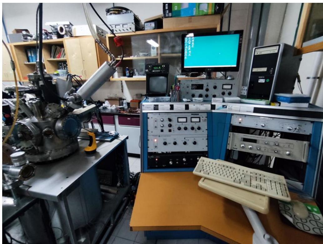
Figura 19. Sistema de medición para XPS y Auger.
