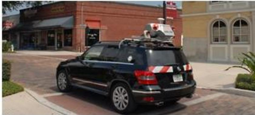
Figura 4. Vehículo equipado con un sistema LiDAR Móvil (Tomada de RIEGL USA, 2011).
