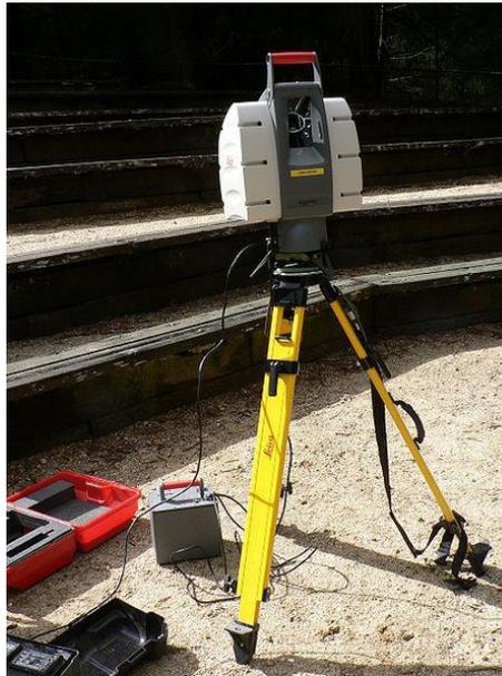
Figura 3. Estación robotizada de LiDAR Terrestre (Tomado de Monniaux, 2007).
