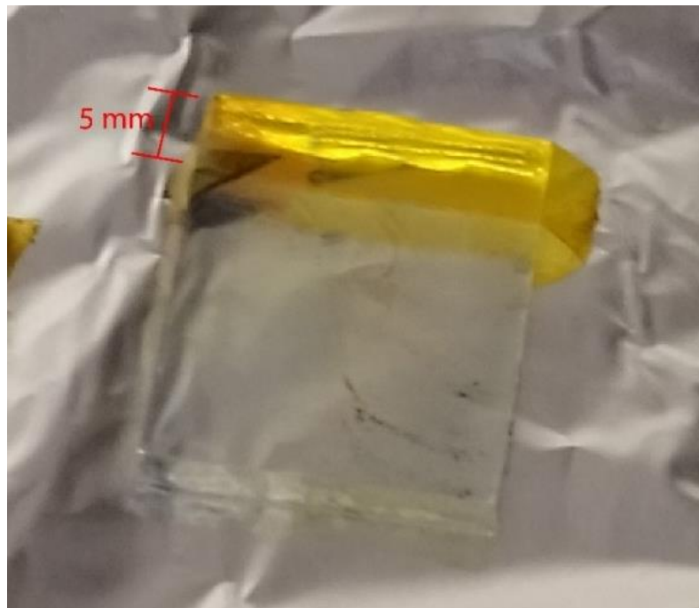
Figura 13. Substrato de FTO con máscara de Kapton.
