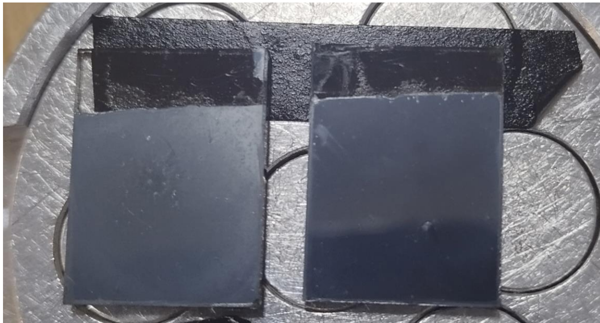
Figura 40. Capas de MAPI elaboradas a 2000 rpm (izquierda) y 3000 rpm (derecha).
