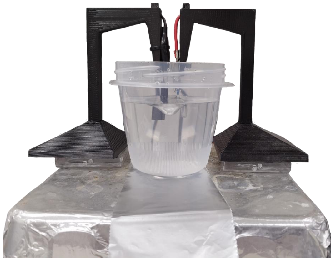
Figura 17. Estación de anodizado diseñada e impresa en 3D en el laboratorio.
