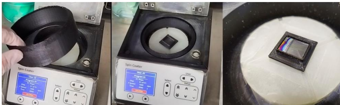
Figura 19. Anillo protector fabricado: antes (izquierda) y después (centro) de colocado en el equipo de depósito por giro (centro). Acercamiento del sustrato colocado en el portasustratos fabricado (derecha).
