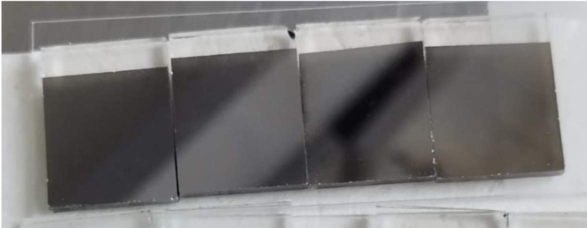
Figura 16. Ti (300 nm)/Dc-TiO 2 /FTO/vidrio elaborado por erosión iónica.
