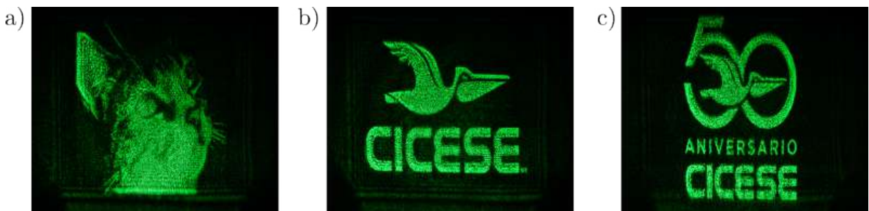
Figura 45. a), b) y c) Distribuciones espaciales de luz resultantes en el plano final ( z = 100 cm) después de la proyección de las pantallas de fase.
