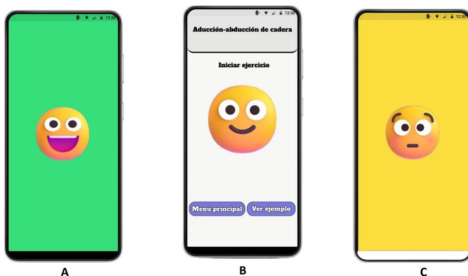
Figura 35. Interfaz de retroalimentación de la segunda versión de la simulación de la aplicación SAFI: A y C indican si el ejercicio se realizó de manera correcta y B es la referencia previa a la clasificación de los movimientos.
