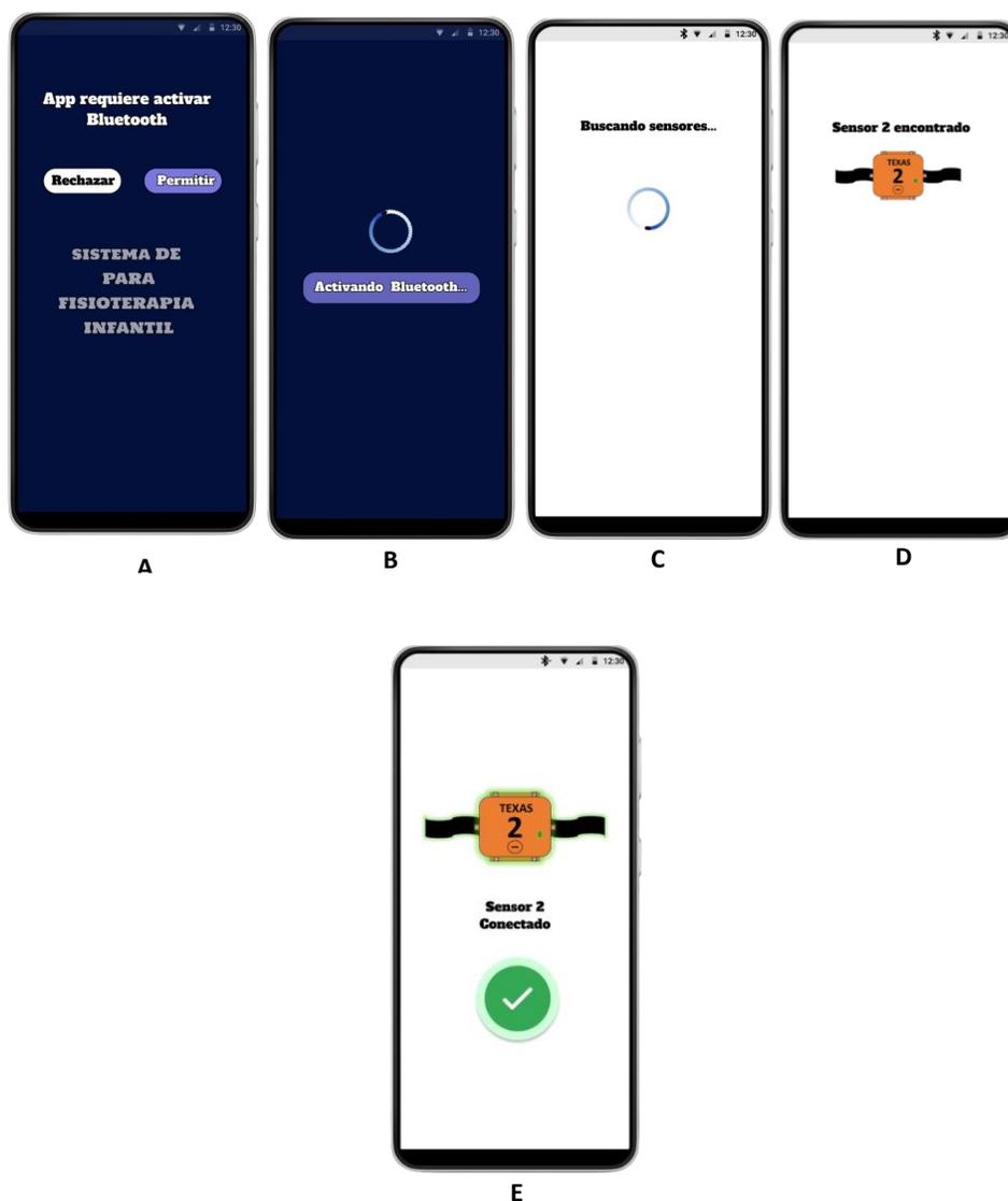
**Figura 33.** Solicitud de permiso para activar la función Bluetooth y búsqueda de los sensores inerciales de la segunda versión de la interfaz de la simulación de la app SAFI.
