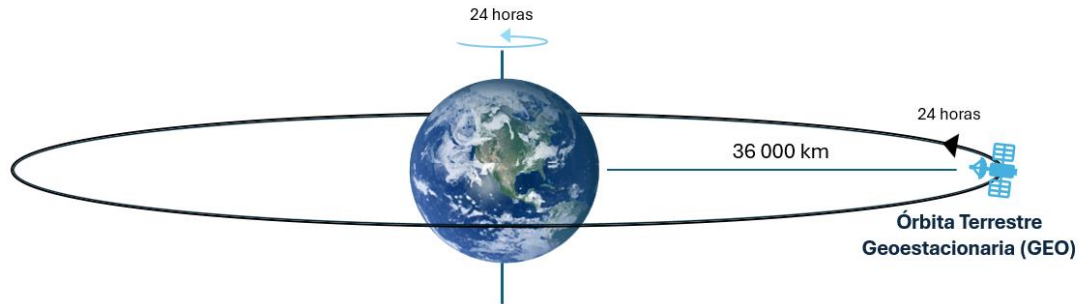
Figura 6. Órbita geoestacionaria Terrestre (GEO).
