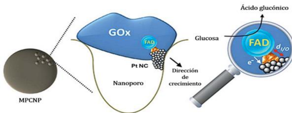
Figura 4. Imagen correspondiente a las configuraciones el electrodo PtNC-GOx/MPCNP sintetizado enzimáticamente de adentro hacia afuera, imagen modificada (Trifonov et al., 2019).
