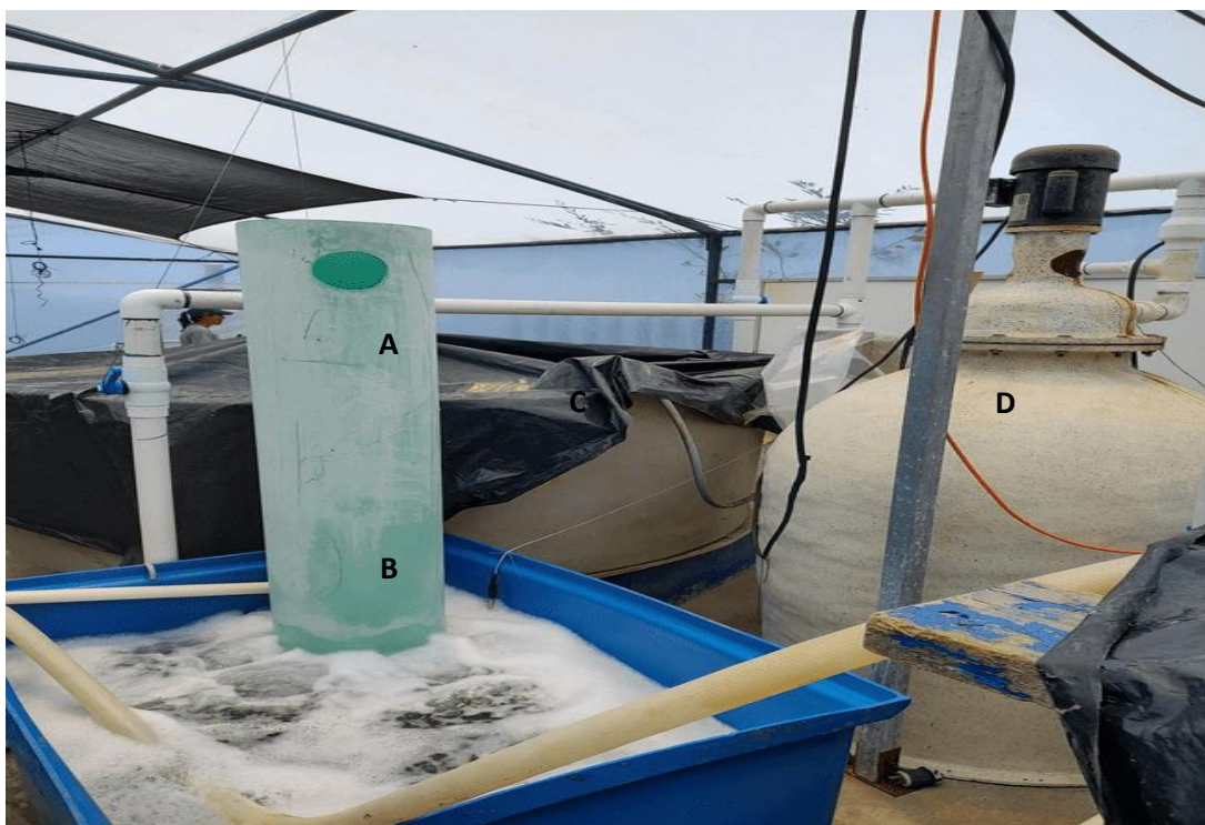
Figura 2.- Componentes del Sistema de Recirculación Acuicola utilizado para evaluar el desempeño biológico del camarón blanco ( Penaeus vannamei ) alimentado con un suplemento de harina de soya fermentada con Saccharomyces boulardii . A) Cascada de agua; B) Tanque de compensación de 300 litros; C) Tanque de compensación de 3.7 m 3 ; D) Biofiltro de propela con cuencas de plástico.
