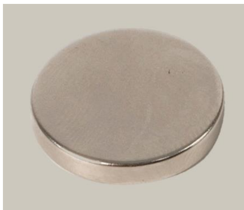
Figura 22. Imán de neodimio utilizado en la caracterización magnética de las soluciones coloidales de NPs.
