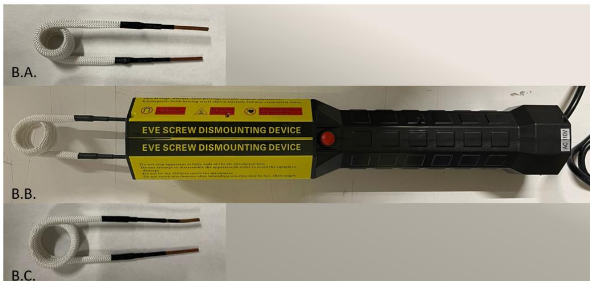
Figura 23. Bobinas utilizadas en la caracterización magnética de las soluciones coloidales de NPs.
