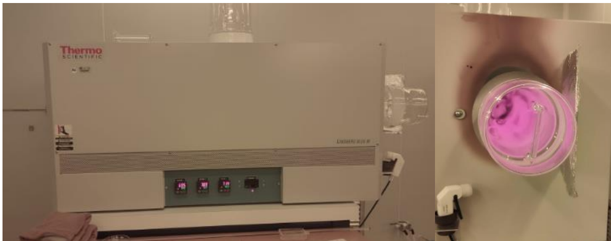
Figura 41. Horno de cuarzo, empleado en el proceso de recocido del BTO.
