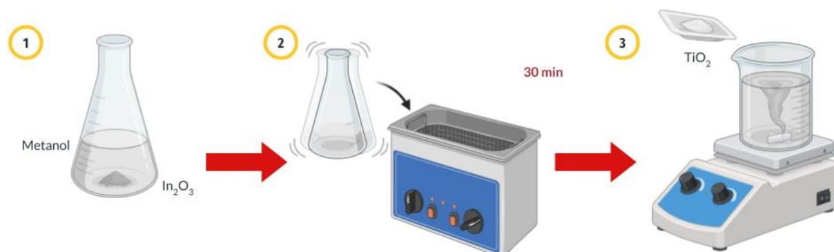
**Figura 12.** Síntesis del nanocompuesto por impregnación húmeda
