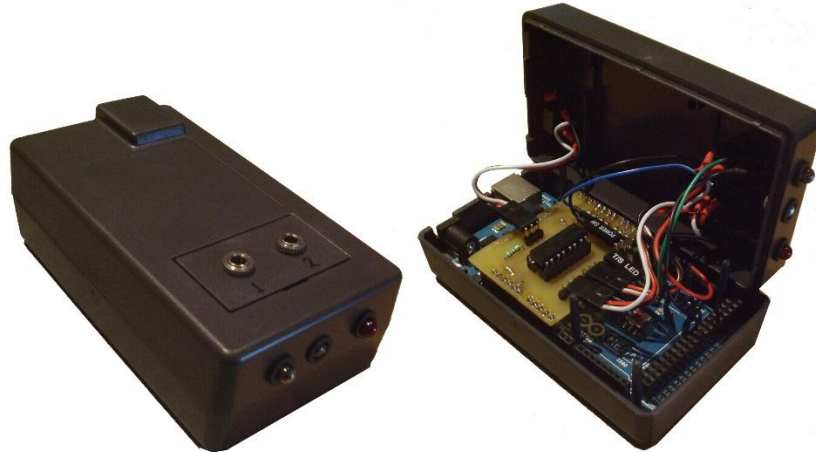
Figura 35. Dispositivo Arduino utilizado para disparar automáticamente la cámara.
