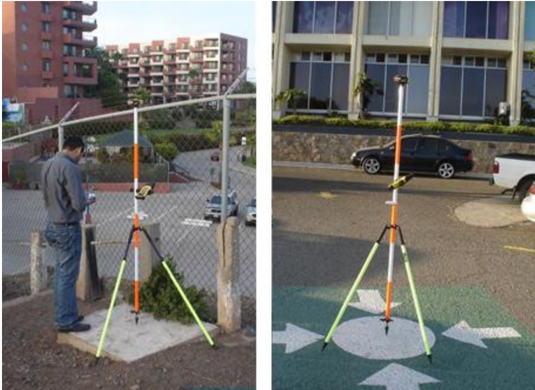
Figura 12. Equipo GPS sobre los puntos de control seleccionados.
