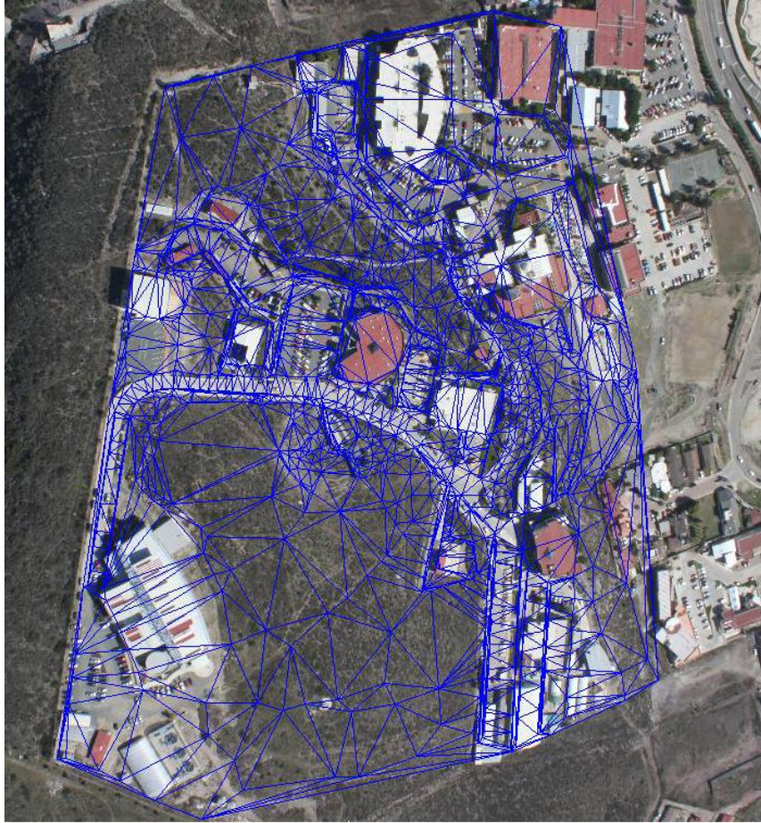
Figura 20. TIN generado a partir de fotografía EOS 500D.
