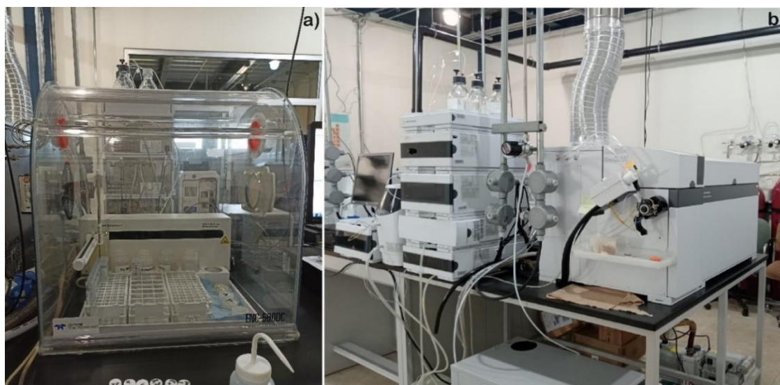
Figura 8. a) Cámara anticontaminación con filtro HEPA. b) Espectrómetro de Masas con Plasma Acoplado Inductivamente (ICP-MS) en el Laboratorio de Análisis de Elementos Traza (LET) del Sistema de Laboratorio Especializado de Ciencias de la Tierra (SLE-CT), Centro de Investigación Científica y de Educación Superior de Ensenada, Baja California (CICESE).
