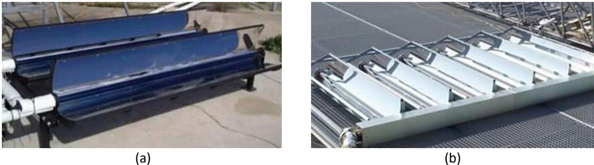
**Figura 12.** Prototipos CPC propuestos por Osório et al. (2019): (a) prototipo 1, (b) prototipo 2.
