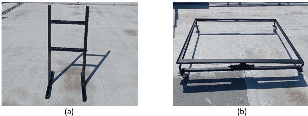
**Figura 35.** Estructuras construidas: (a) para instalar el calentador eléctrico y (b) para inclinar el colector CPC.
