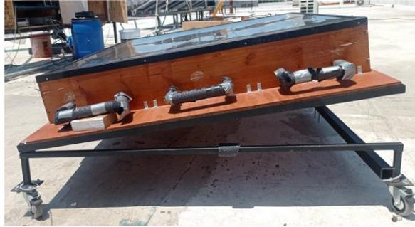
**Figura 38.** Colector CPC orientado hacia el sur e inclinado 10°.
