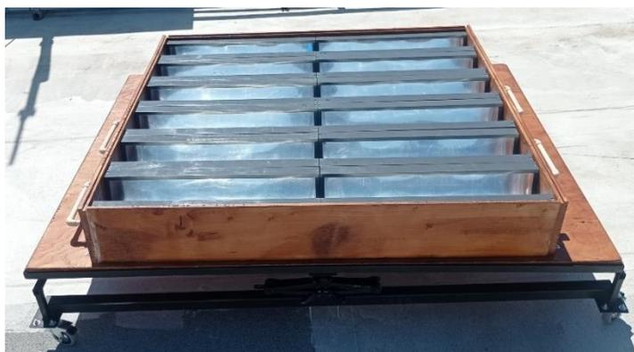
**Figura 33.** Colector CPC construido.
