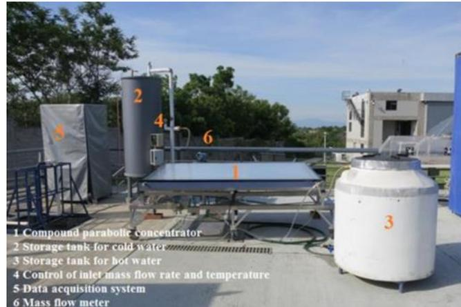
**Figura 13.** Configuración experimental propuesta por Santos-González et al. (2017).
