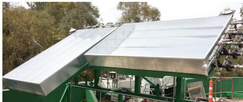
**Figura 14.** Colectores diseñados por Aguilar-Jiménez et al. (2018) e instalados en la estructura soporte.
