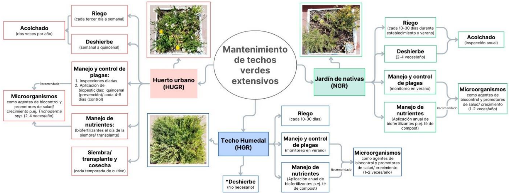
Figura 26. Guía de actividades de mantenimiento y frecuencia de las actividades de tres tipos de techos verdes extensivos.
