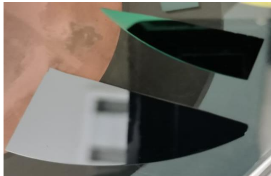
Figura 69. Muestra de ZnO con un espesor de 420 \text{ nm} \pm 10 \text{ nm} , donde la muestra central ha sido tratada mediante RIE.
