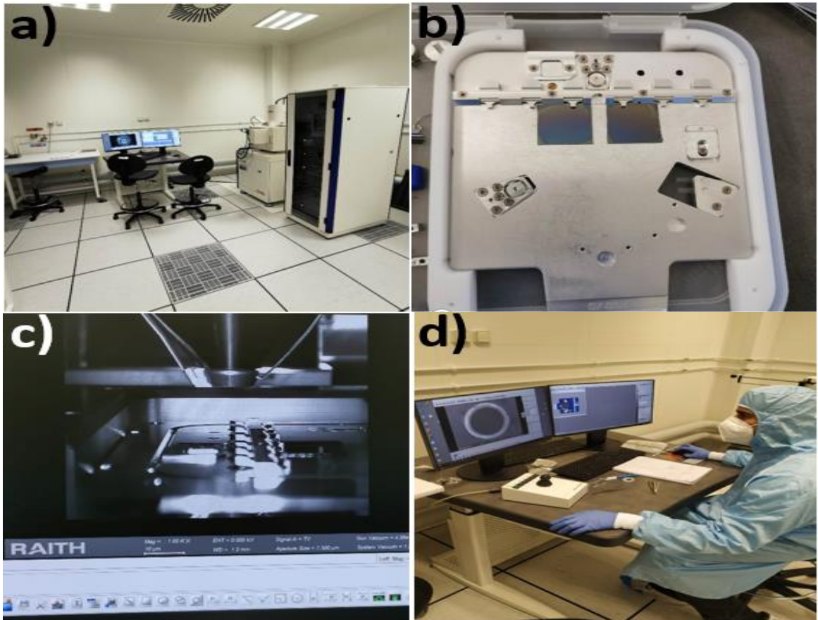
Figura 33. Fotografías del cuarto limpio de la UTT, a) Equipo de litografía por haz de electrones, b) porta muestras, c) imagen del cañón del SEM, d) procedimiento de calibración del SEM.
