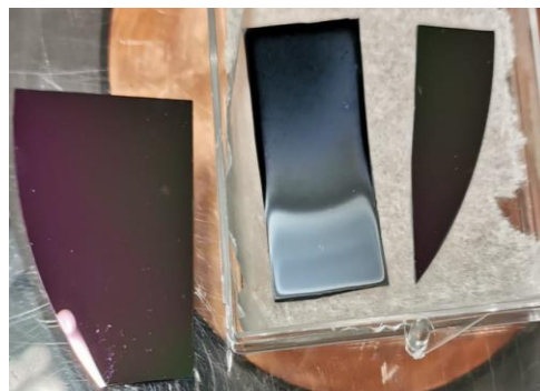
Figura 67. Muestra de \text{Al}_2\text{O}_3 con un espesor de 1000 \text{ nm} \pm 10 \text{ nm} , siendo la del centro la que fue tratada mediante RIE.
