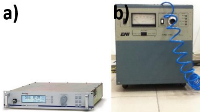
Figura 42. Generador de potencia RF a) 300 W para RIE y b) 2 kW para ICP.
