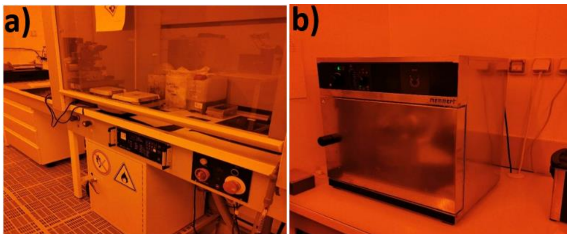
Figura 29. Equipo para depósito de polímero: a) centrifugadora y b) horno térmico. Fotos cuarto limpio UTT.
