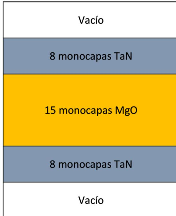
**Figura 18.** Modelo estructural empleado para calcular la interfase TaN/MgO.
