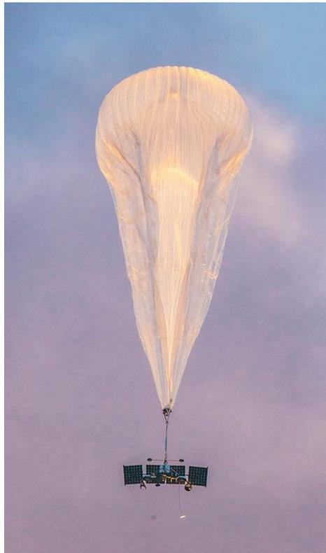
**Figura 9** El proyecto *Loon*, exitosamente realizó comunicaciones aire-aire con una velocidad de datos de 0.15 Gbps (X Company, 2024).
