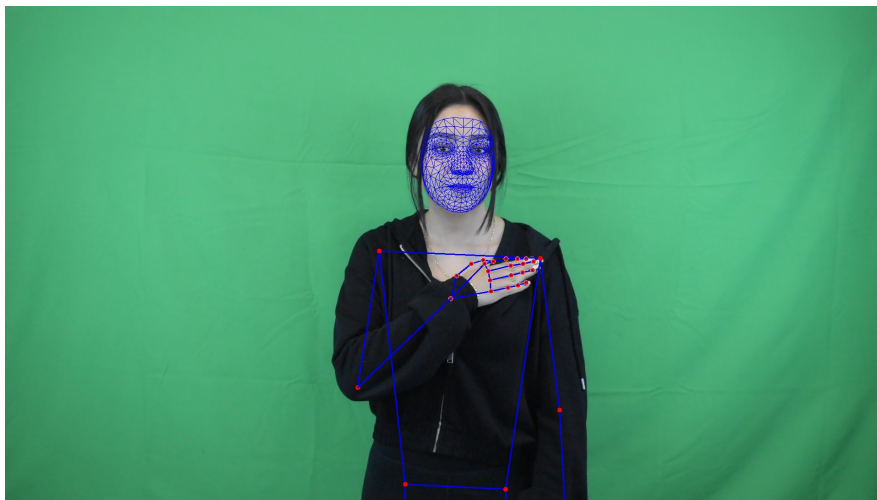
Figura 8. Imagen representativa de la salida obtenida del framework MediaPipe Holistic .
