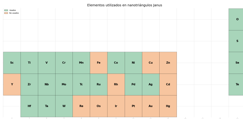
Figura 5. Distribución de elementos en los nanotriángulos Janus de fórmula general MXY . Se incluyen los metales de transición de los grupos III–XII y los calcógenos del grupo XVI. En color verde se resaltan los elementos empleados en la generación de la base de datos, y en naranja aquellos no utilizados.
