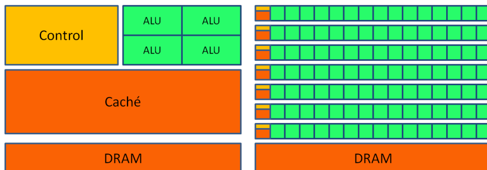
Figura 7: Asignación de transistores en la arquitectura de CPUs y GPUs (NVIDIA, 2008).
