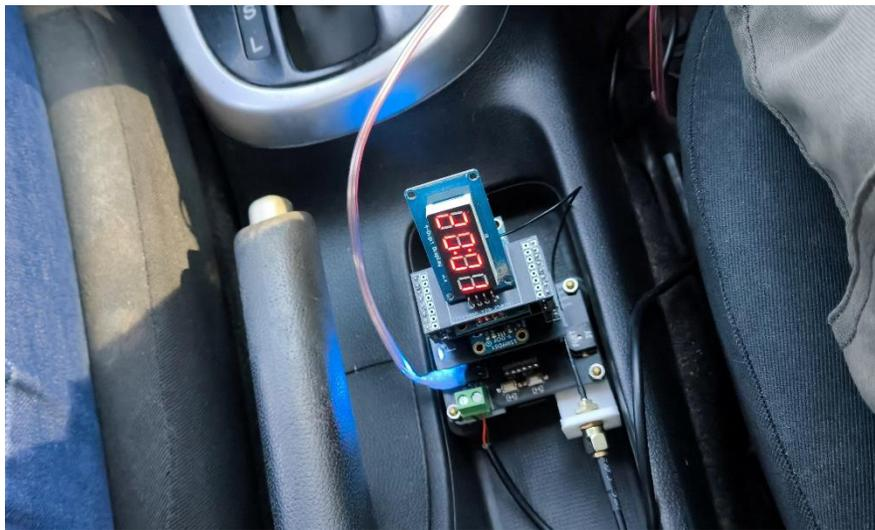
**Figura 6.** Dispositivo de captura de datos inerciales utilizados en las pruebas de estudio.
