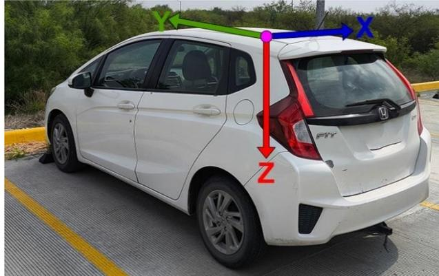
**Figura 7.** Orientación de los ejes de los sensores inerciales utilizados, dentro del vehículo de prueba
