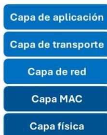
**Figura 1.** Modelo de referencia OSI
