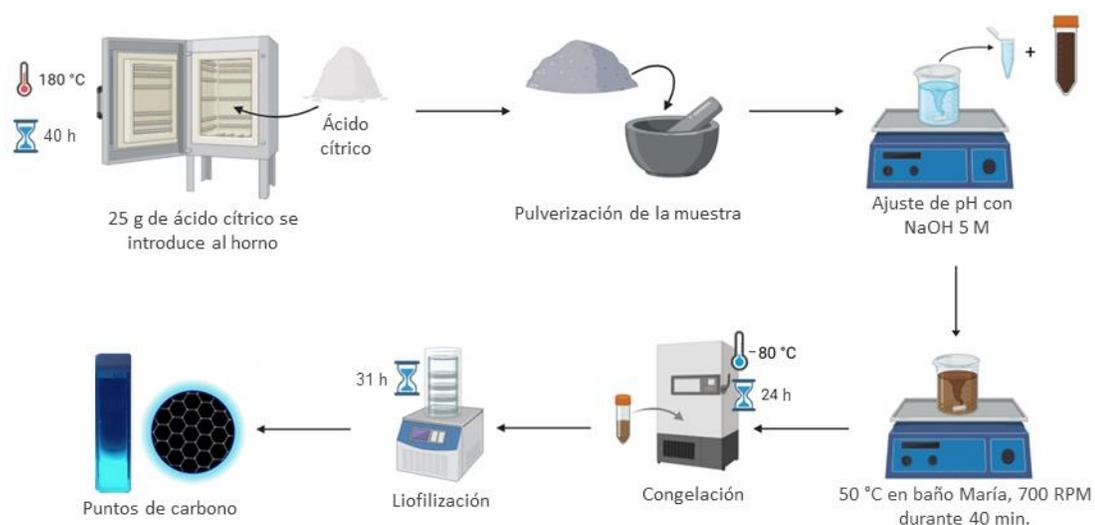
**Figura 14.** Metodología de la síntesis de puntos de carbono (CD). Los CD se obtuvieron a partir de la termólisis de ácido cítrico a 180 °C durante 40 h, la muestra se pulveriza y después se neutraliza con NaOH 5 M durante 40 min, para después congelar a -80 °C por 24 h y liofilizar por 31 h los CD. NaOH: hidróxido de sodio. Creado en Biorender.
