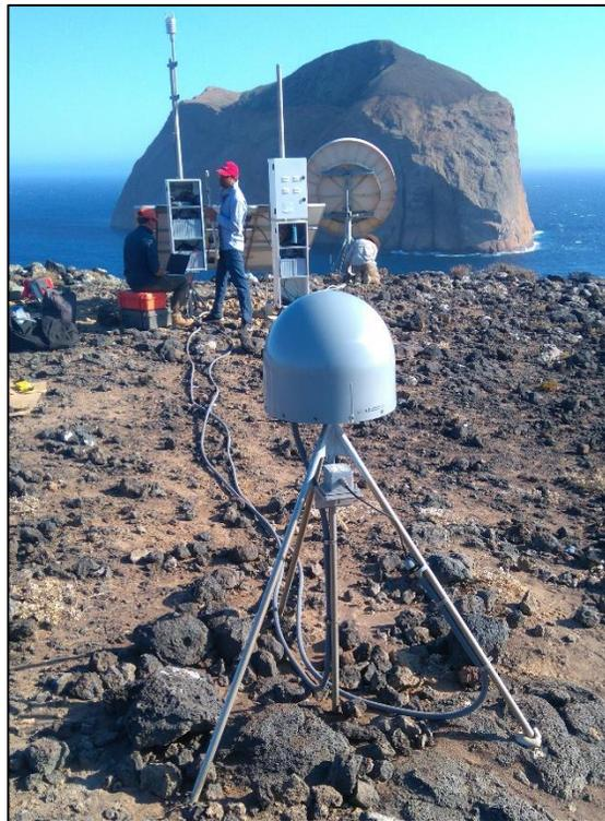
**Figura 16** Instalación de la estación cGPS GUAX en Isla Guadalupe. Se observa el domo protector de la antena GPS, la antena trasmisora, los paneles solares y las cabinas de aluminio con las baterías y receptor GPS.
