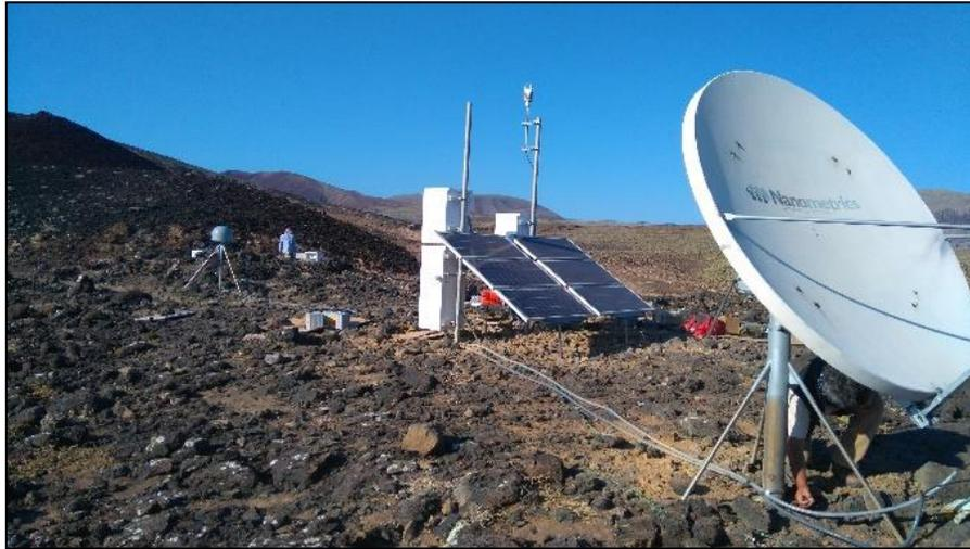
**Figura 22** Instalación de la estación cGPS GUAX. Instalada con el apoyo de UNAVCO, cuenta con 6 paneles solares y antena transmisora de las observaciones en tiempo real.
