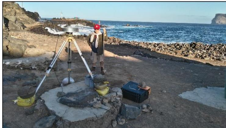
**Figura 21** Instalación de la estación GPS temporal RMGU instalada en Isla Guadalupe.
