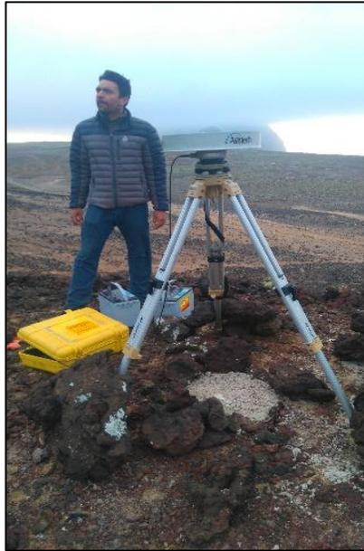
**Figura 20** Instalación de la estación GPS temporal GUAD instalada en Isla Guadalupe.
