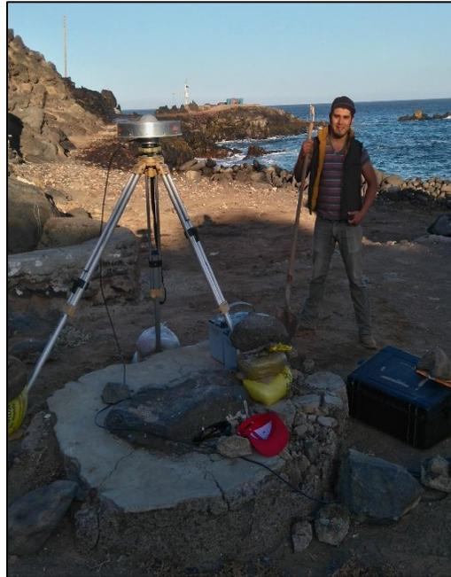
**Figura 17** Instalación de la estación GPS temporal RMGU en Isla Guadalupe, Baja California, México.
