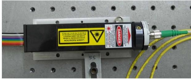
Figura 14. Láser de estado sólido Nd:YAG acoplado a fibra óptica.
