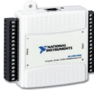
Figura 42. Tarjeta de adquisición de datos *NI USB-6009* de 8 entradas analógicas con una resolución de 14 bits y una velocidad máxima de muestreo de 48 KS/s.
