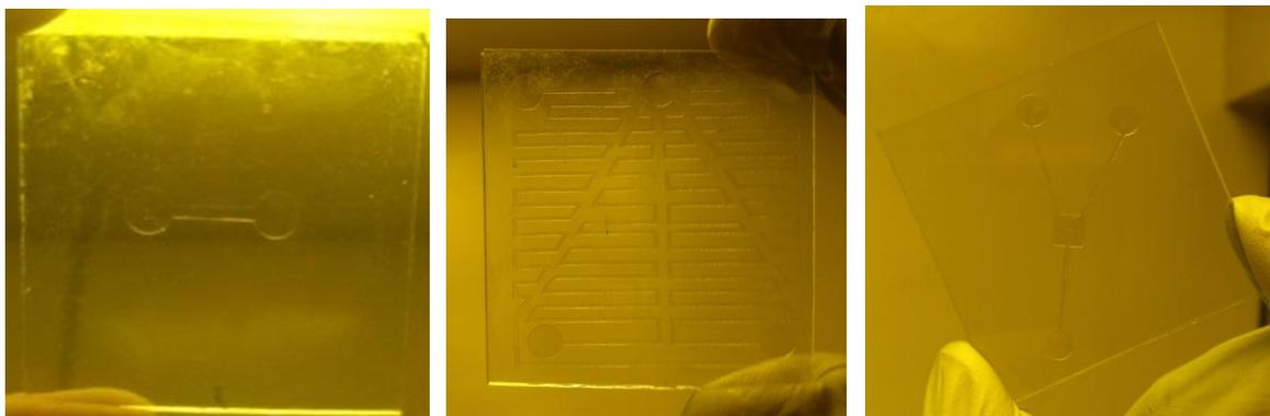
Figura 12: Fotografía del maestro grabado completamente en fotorresina SU-8 2100.
