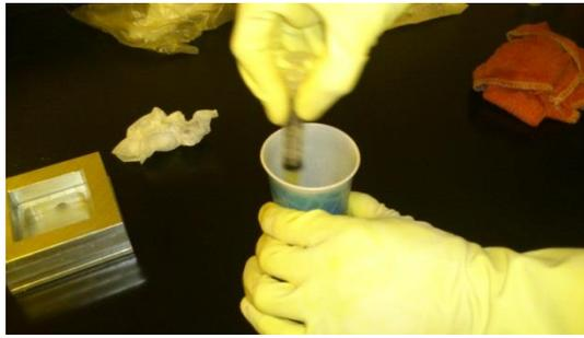
Figura 14: Mezcla de elastómero con el agente de curado.
