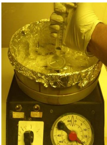
Figura 8: Deposito de la fotorresina y centrifugado.
