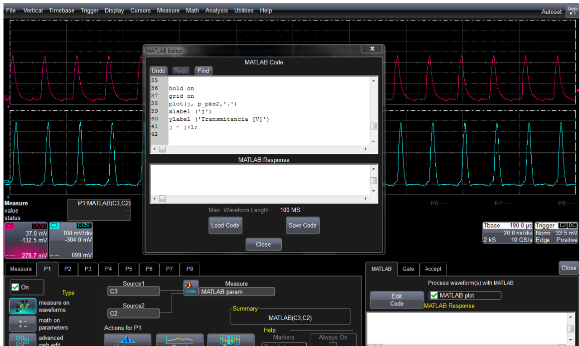
Figura 19. Señales del tren de pulsos del láser resuelto capturadas simultáneamente. Ruta para programación del osciloscopio Measure > Measure Setup > P1 > Measure > MATLAB param > Edit Code > load Code > Z_ambos.m > ok.
