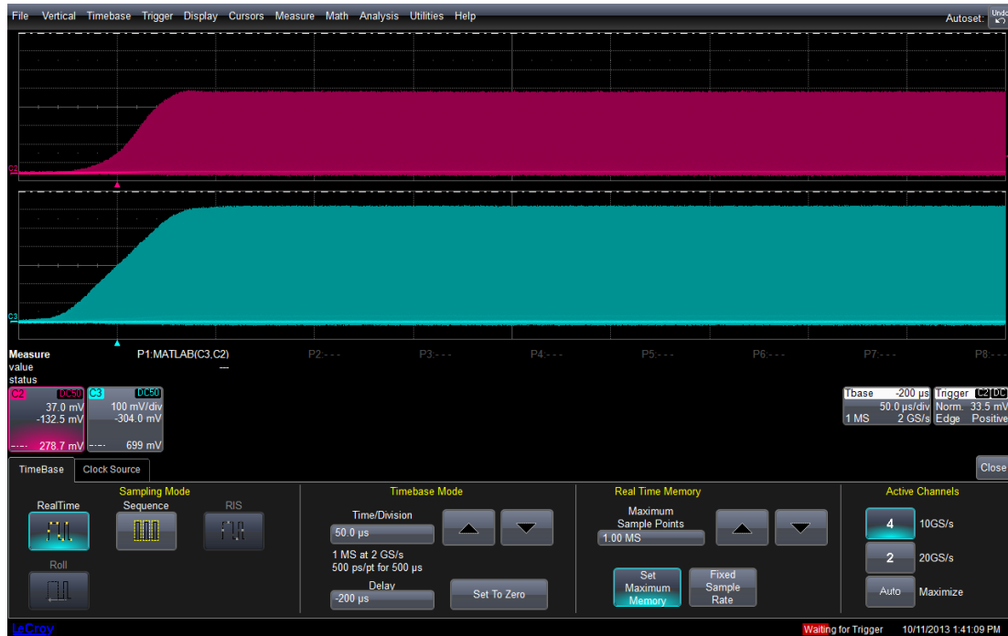
Figura 21. Vista típica de la pantalla del osciloscopio con el tren de pulsos capturado simultáneamente (señal roja y azul) para una posición de la muestra. Ruta para seleccionar la frecuencia de muestreo; Timebase > Horizontal Setup > Maximum Sample Points. Ruta para guardar datos; File > Save Wavefront > Source > Trace Title Format > Subformat > Fill > Browse > Save Now.
