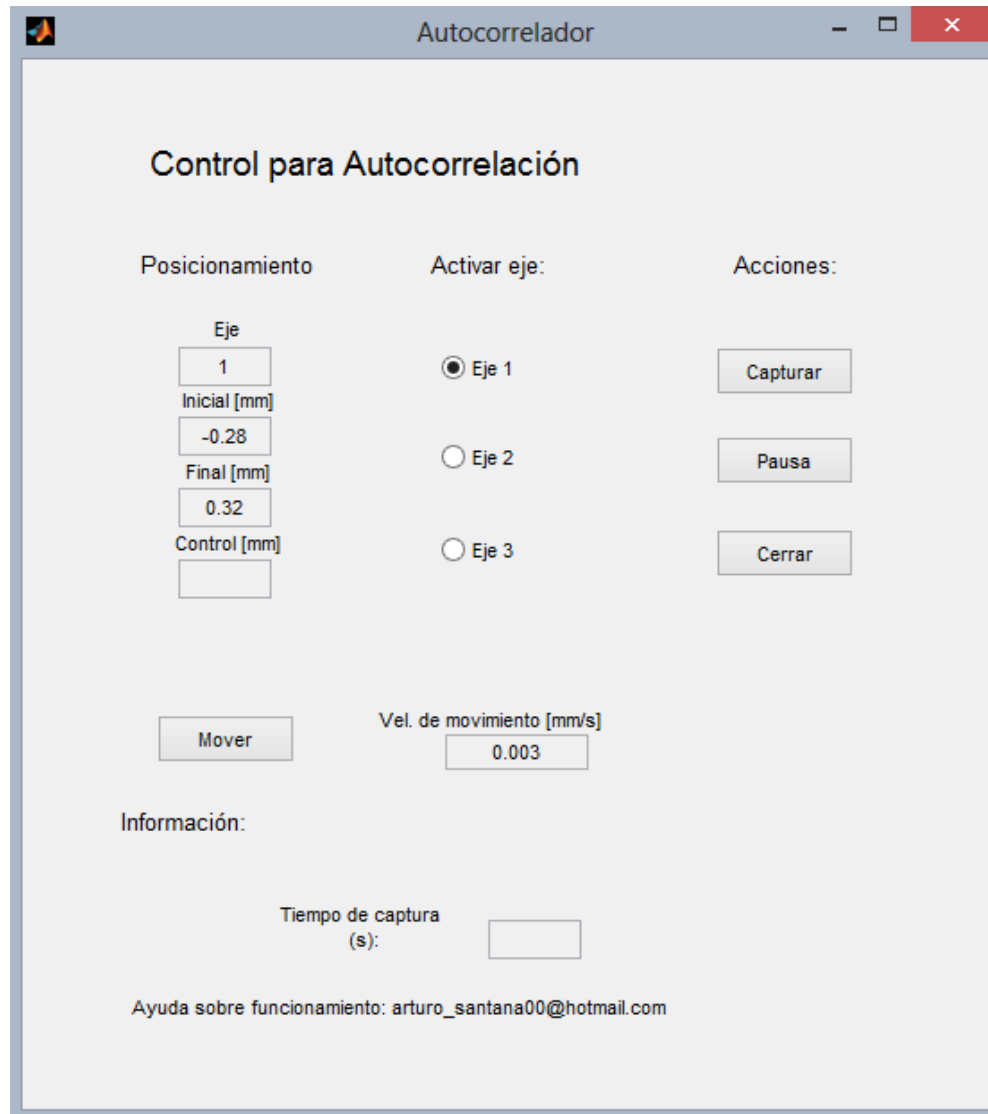
Figura 11. Interfaz del control de movimiento para la compensación de los caminos ópticos para el desarrollo de los experimentos de autocorrelación.
