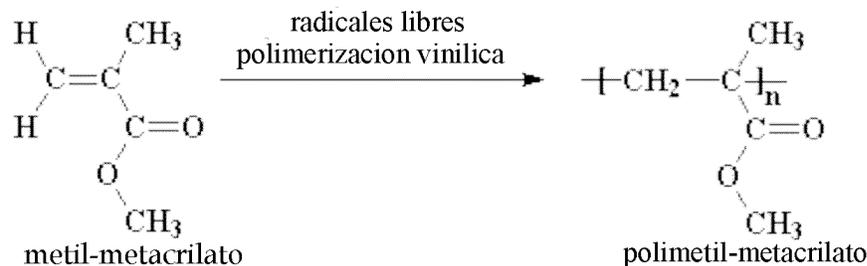
Figura 2. Estructura química del PMMA. <http://www.pslc.ws/mactest/pmma.htm>
