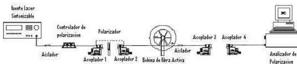
Figura 12. Arreglo utilizado para la caracterización de la birrefringencia que presenta el bobinado helicoidal.
