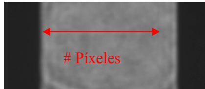
Figura 46. Seleccionamos un renglón de la imagen y contamos cuantos píxeles son iluminados para cierta apertura.
