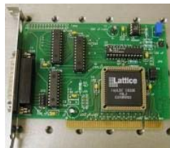
Figura 50. Tarjeta PCI DAC de 8 bits de resolución con 24 salidas analógicas, el voltaje puede ser ajustado entre 2.5 y 10Vmax para todos los canales
