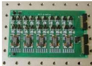
Figura 51. Tarjeta amplificadora, cuenta con 20 canales y un factor de amplificación de 56.
