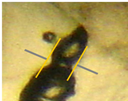
Figura 41. Burbujas generadas a la fluencia umbral irradiando a 400 µm de profundidad, dimensión de las burbujas ~ 30 µm. Frecuencia de repetición de 3 Hertz, velocidad de barrido 250 µm/seg.
